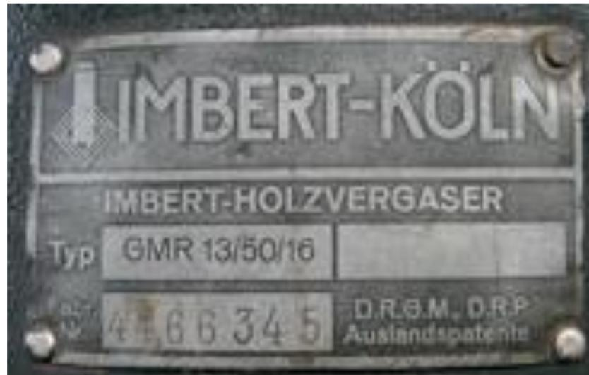
**Questo gasogeno , che produce un combustibile derivandolo da tronchetti di legno , fu usato per autotrazione (automobili , autocarri , autobus e motocicli) ed anche in agricoltura (trattori , motocoltivatori e motori fissi).**
